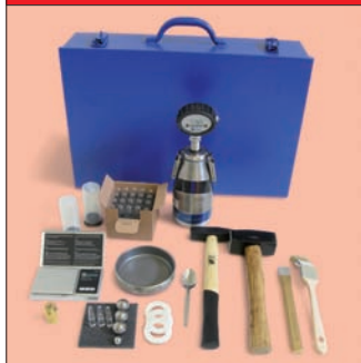
Composition de la mallette de base (B) et de l'appareil de mesure CM Business (D).
