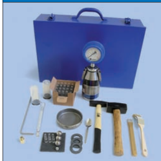
Composition de la mallette de base (A) et de l'appareil de mesure CM Classic (C).
